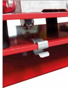
Passe-câble pour une protection du câble d'éclairage
