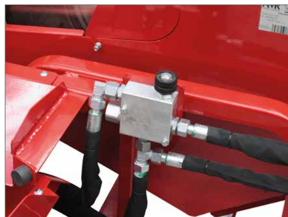
Réglage possible de la vitesse du convoyeur
