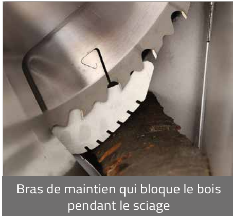
Bras de maintien qui bloque le bois pendant le sciage
