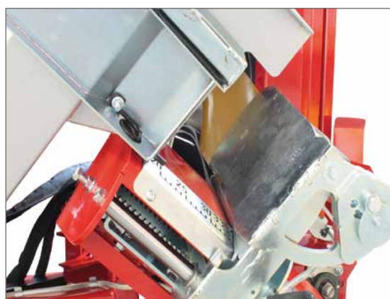
Butée en sortie de chevalet avec capteur de présence de bûches pour l'automatisation du basculement du chevalet
