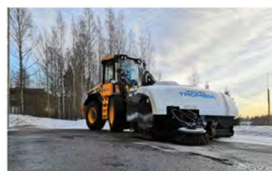
Balayage par températures en dessous de zéro. Trombia n'utilise pas d'eau risquant de geler au sol!
