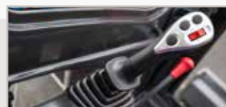
Manipulateurs proportionnels avec molette de commande du circuit hydraulique auxiliaire
