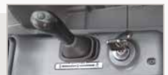
Fonction de flottement de la lame de remblayage et sélection de la gamme de vitesse
